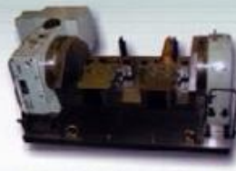
水龍頭第四軸MC治具 Tap fourth axis MC fixture
