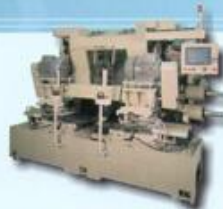
水車轉塔式加工專用機 8-station trunnion machine
