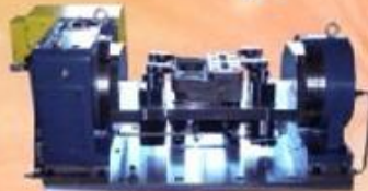
■ 剎車器第四軸 M/C 加工治具 Brake fourth axis machine M/C fixture
